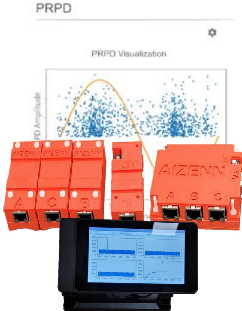
전력용케이블, 전력용변압기, 인버터, 고압 전동기 및 발전기 장치에 대한 독자적인 PD 기술을 활용한 정확하고 신뢰성 있는 온라인 부분 방전 시스템
